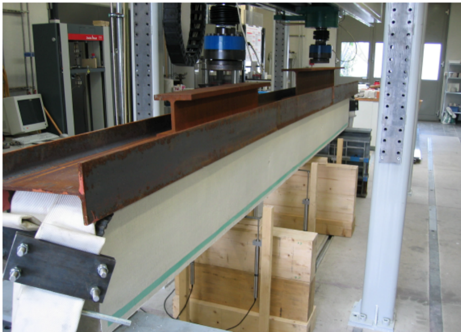
Bild 18: Versuchseinrichtung für Balkenversuche mit gleichmäßig verteilter Belastung [1]
